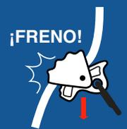
Este dispositivo, en caso de una caída, se activa automáticamente presando la cuerda, lo que evita que el usuario caiga.
